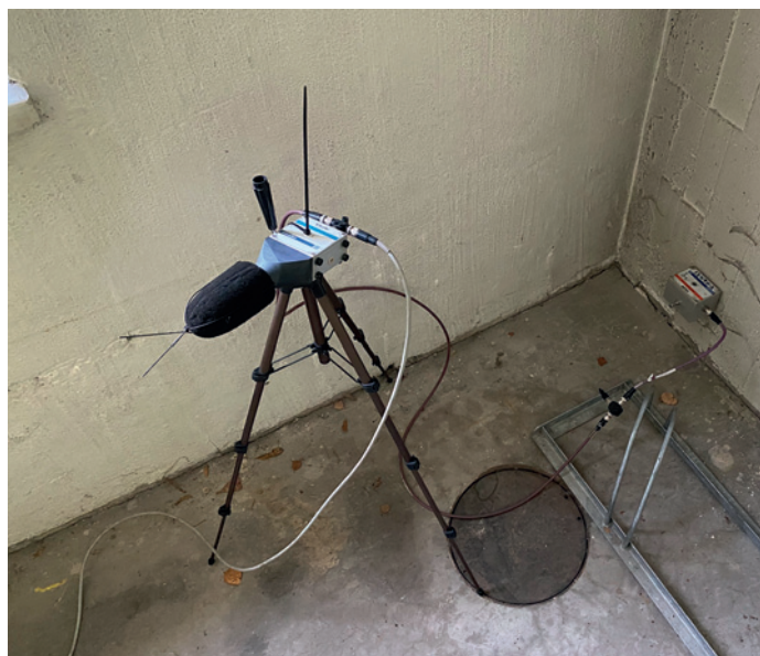
Figur 2: Exempel på placering av öövervakad och stationär stömljuds- samt vibrationsmätning i källare till ett bostadshus. Vibrationsensorn är placerad i utrymmets hörn nära betongplattan.
